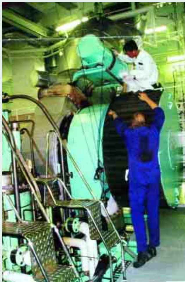
Η επιθεώρηση και ο καθορισμός της κατάστασης του TCA77 στροβιλοφουσητήρα.
