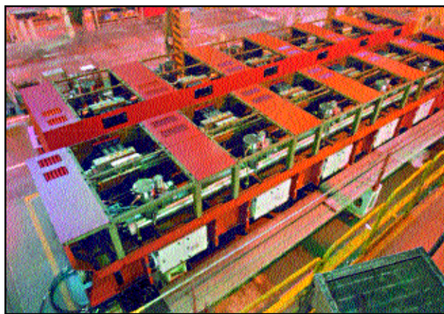
Σχ. 10. Τα δύο τμήματα των μονάδων κοινού οχετού μίας 12-κυλίνδρου μηχανής RT-flex 96C κατά τη διάρκεια της άρμωσης.
