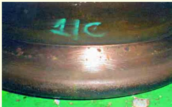
Σχ. 4. Περιορισμένα ανώμαλα σημεία στην επιφάνεια της έδρας βαλβίδος κατασκευασμένης με μέθοδο «DURASPINDELE»
