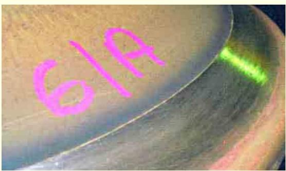
Σχ. 5. Κανένα ανώμαλο σημείο σε μία έδρα βαλβίδος «DURASPINDELE» η οποία χρησιμοποιείται σε σχέση με τη «W-έδρα»
