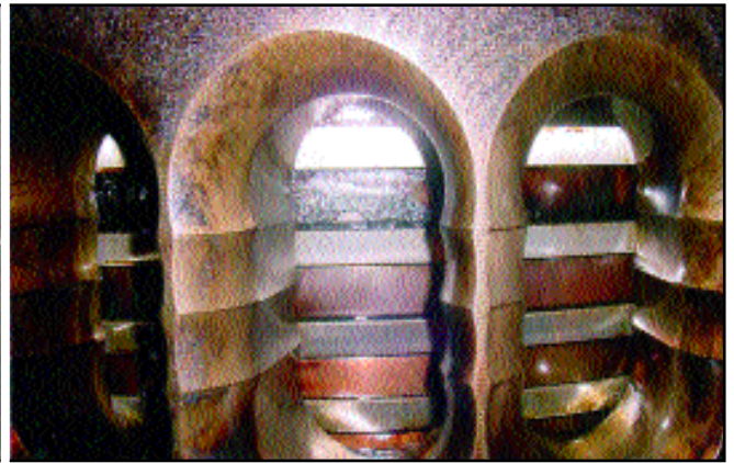
Σχ. 6 Τυπική κατάσταση των ελατηρίων του εμβόλου για ένα ρυθμό παροχής κυλινδρελαίου της τάξης του 1,0 G/KWH. Η παραπάνω κατάσταση των ελατηρίων συμπίπτει με την περίπτωση του σχ. 5
